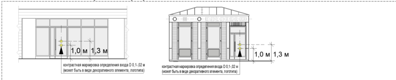
Рис. 37. Внешний вид контрастной маркировки входа.
